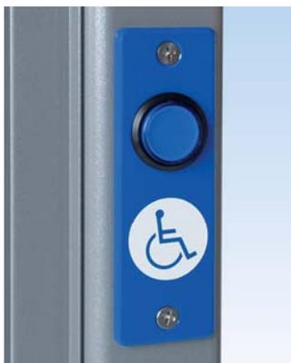
Кнопки для инвалидов находятся внутри и снаружи на стойках карусельной двери. При нажатии на кнопку для инвалидов дверь замедляется до скорости для инвалидов. После установленного количества вращений дверь ускоряется до обычной скорости вращения на два оборота. Затем дверь снижает скорость (режим работы "Постоянное вращение") или останавливается в начальном положении.
