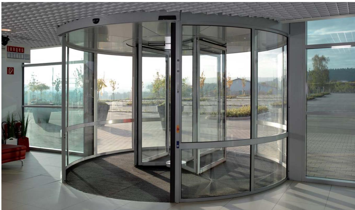
Карусельные двери для больших помещений GU GGR имеют складывающиеся створки и поэтому подходят для использования на путях эвакуации. Это было подтверждено и сертифицировано испытаниями TÜV. В обычном режиме створки надежно фиксируются электромагнитами, предотвращая таким образом непреднамеренное складывание вследствие толкания или ветровой нагрузки.
