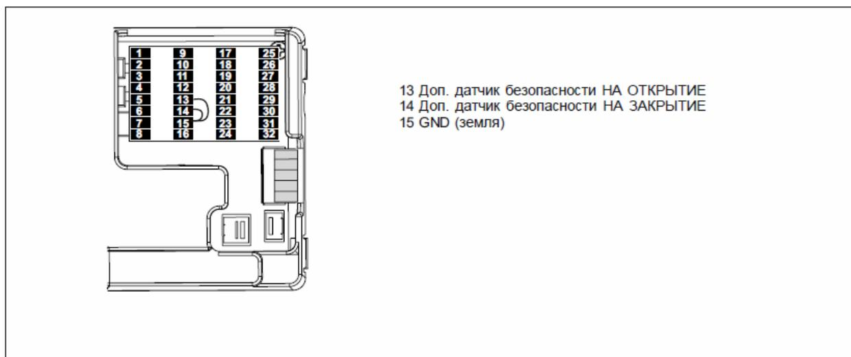
Если используются датчики безопасности «неконтролируемого» типа, то перед процедурой обучения требуется изменить параметр **PARAMETERS -> Movement parameters -> Safety Logic**, поменяв его на вариант работы без тестового сигнала.
