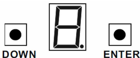
В зависимости от варианта установки электронная плата может оказаться расположенной вверх ногами. В таком случае нажмите одновременно DOWN и ENTER на 1 секунду и информация на дисплее развернется на 180 градусов.
