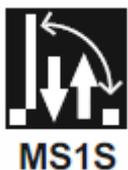
Дверь открывается полностью в автоматическом режиме. Открытие происходит по команде радара, а закрытие выполняется автоматически (время регулируется).
